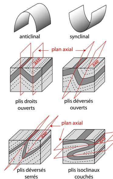
Figure 35 - Schéma montrant les différents types de plis.
